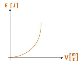
Abbildung 1:  $E = \frac{1}{2}mv^2$ , Bezeichnung der Größen und Einheiten. Achsenbeschriftung am Diagramm.
